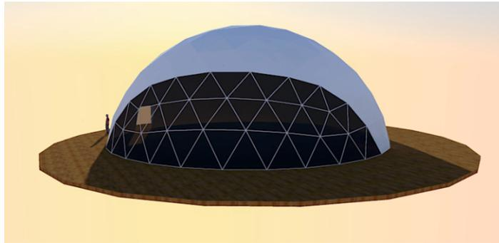
**Конструктивное решение:** конструкция представляет собой многогранную решетчатую пространственную конструкцию в форме купола
